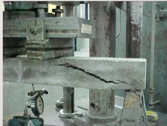
Falla por tensión diagonal de vigas
